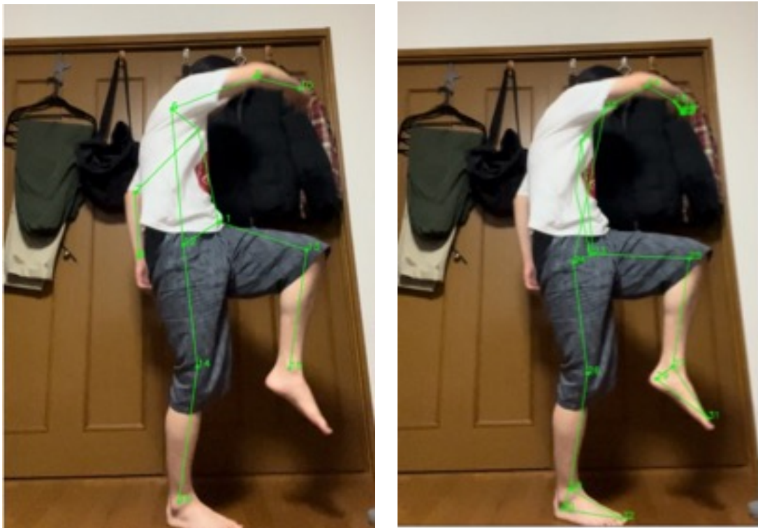
図 5 : MoveNet と Mediapipe の比較例 1 (左 : MoveNet, 右 : Mediapipe)
