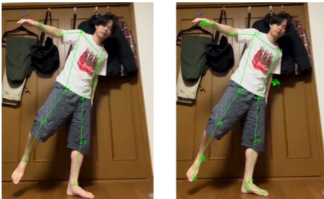
図 6 : MoveNet と Mediapipe の比較例 2 (左 : MoveNet, 右 : Mediapipe)
