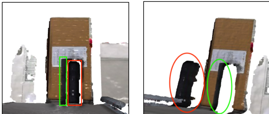
図 18 トイレトペーパーの芯を点群化した結果
