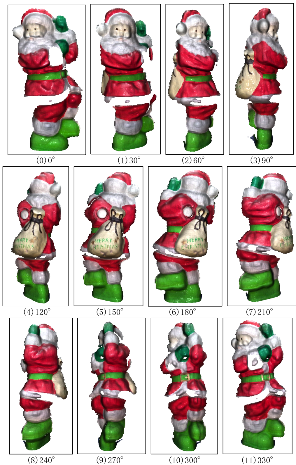
図 22 全周方向から撮影した物体の点群
