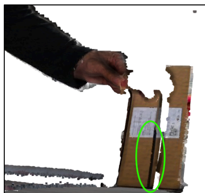
図 15 割り箸を点群化した結果
